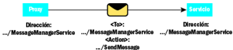
Figura 3 Direccionamiento típico sin enrutador (Hacer clic en la imagen para ampliarla)
